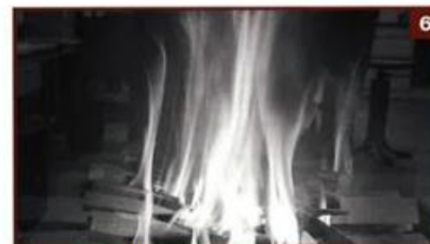
6- Lorsqu'il ne reste plus qu'un lit de braises ardantes sur la grille, remettez 2 ou 3 bûches de section adaptée à votre besoin de chauffe du moment et réduisez légèrement l'amenée d'air, si nécessaire (il vaut mieux limiter la quantité de bois, que d'air !).
