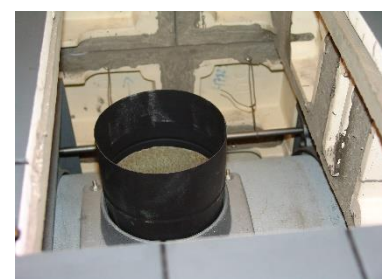
6- Libérer le tuyau coulissant et remettre en place l'ensemble tuyau et catalyseur, ainsi nettoyé
