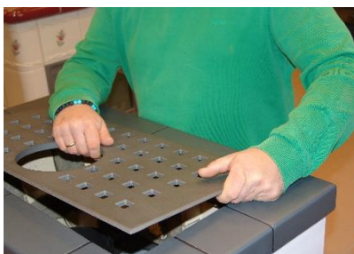
7- Repositionner la grille centrale en fonte
