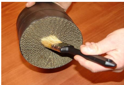
5- Ne pas omettre de nettoyer le catalyseur à l'aide d'un pinceau souple
