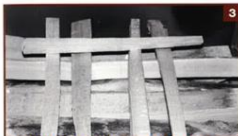
3- En sens croisé, disposez une seconde couche de bois refendu de petite section, ou de bois d'usage du commerce, en veillant à conserver un passage d'air entre eux.
